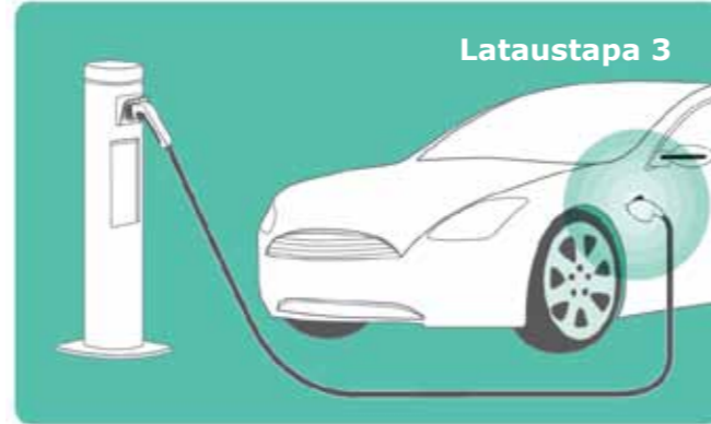
Suomen olosuhteisiin soveltuva lataustavan 3 pistorasiarakenne (tyyppi 2).
