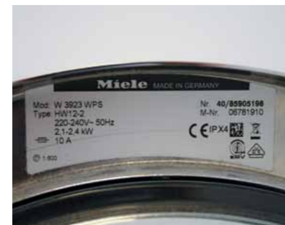
Standardin EN 60335-2-7 edellyttämä pyykinpesukoneen kotelointiluokka IPX4 on merkitty koneen arvokilpeen.
